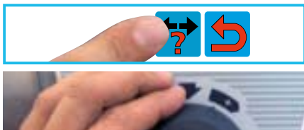
Wahl-Taste drücken und mit Zentralem Einstellrad weiterblättern
