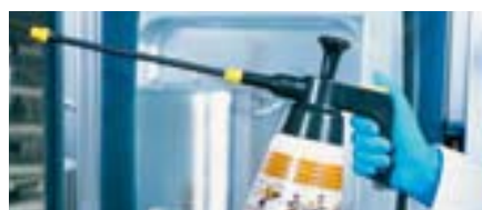
Raum hinter dem Luftleitblech, Garraum, Türinnenseite, Türdichtung mit Reiniger einsprühen
