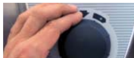
Klima-Taste drücken und maximale Garraumfeuchte einstellen (siehe Kapitel „ClimaPlus Control®“)
