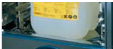
Kanister mit Entkalkungsflüssigkeit in den Garraum stellen und Schlauch in den Kanister führen
