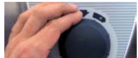
Kerntemperatur-Taste drücken und Kerntemperatur einstellen
