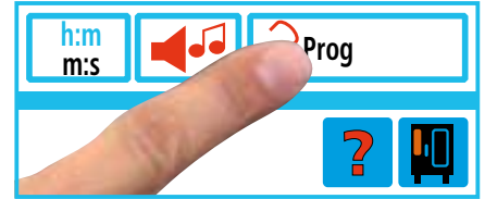
Taste für Programmiersperre drücken
