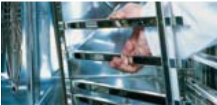
Einhängegestell links entnehmen
