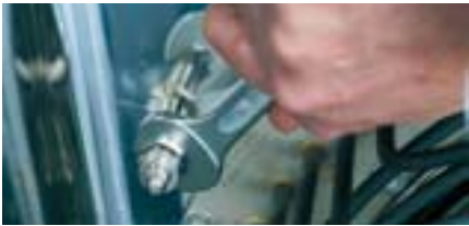
Überwurfmutter der Beschwadungsdüse lösen (Drehrichtung gegen Uhrzeiger – Schlüsselweite 15).
