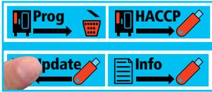
Update-Taste drücken, Software wird aktualisiert – Gerät startet automatisch
