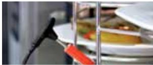
Kerntemperaturfühler in das Keramikrohr am Tellerhordengestellwagen setzen
