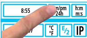
Echtzeit-Format drücken. Eingestelltes Echtzeit-Format leuchtet rot (Datumsformat wird automatisch umgestellt)
