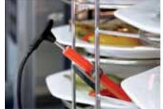
Setzen Sie bei Finishing® „Teller Bankett“ den Kerntemperaturfühler in das Keramikrohr am Tellerbordengestellwagen.
