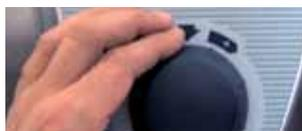
Garzeit-Taste drücken, das Zentrale Einstellrad nach links drehen bis „DAUER“ angezeigt wird
