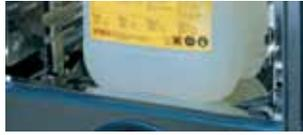
Kanister mit Entkalkungsflüssigkeit in den Garraum stellen und Schlauch in den Kanister führen
