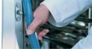
Die Türdichtung ist in eine Führung am Garraum gesteckt.
