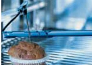
Verwenden Sie die Positionierhilfe, wenn die Möglichkeit besteht, dass sich der Kerntemperaturfühler selbstständig aus dem Gargut löst. (z. B. Lebensmittel mit weicher Konsistenz oder geringer Dicke).
