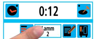
Programmschritt-Taste drücken, Programmschritt 2 wird angezeigt
