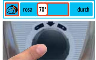
Die Eingabe wird innerhalb 4 Sekunden automatisch übernommen oder Sie drücken (Push-Funktion) auf das Zentrale Einstellrad.
