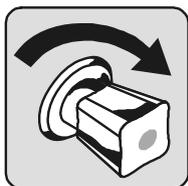
Absperrventil der Wasserzuleitung schließen<sup>2</sup>.
