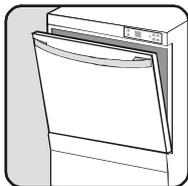
Öffnen Sie die Türe leicht. Hierzu ist eine Raststellung im Türverschluss vorgesehen. Der Innenraum kann dadurch besser austrocknen. Dies ist für einen dauerhaften Korrosionsschutz auch bei Edelstahl wichtig.
