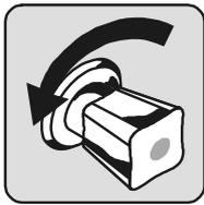
Absperrventil der Wasserzuleitung öffnen.
