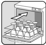
Den gefüllten Spülkorb in die Maschine schieben und die Türe schließen.
