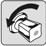
Absperrventil der Wasserzuleitung öffnen.
