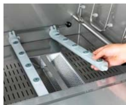
Untere und obere Spülarme einsetzen
