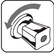
Absperrventil der Wasserzuleitung öffnen.
