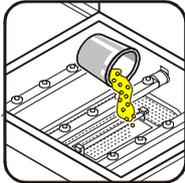
Reinigerpulver mit Becher in Siebkassette schütten.
