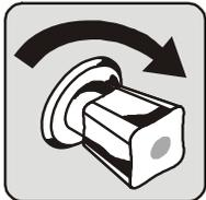
Absperrventil der Wasserzuleitung schließen.
