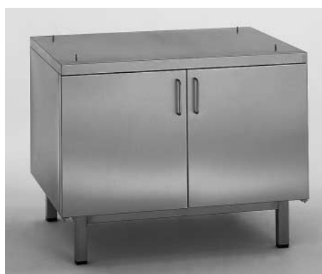
Unterschrank US IV Rahmengestell komplett mit Ablageboden, höhenverstellbaren Füßen, 14 Paar geprägten Auflageschienen, allseitig geschlossen, mit zwei doppelwandigen Flügeltüren.
