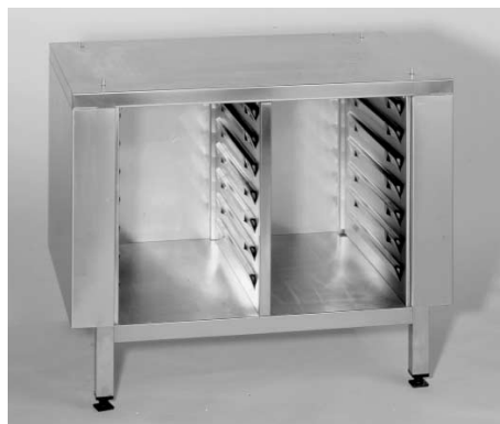
Unterschrank US III Rahmengestell komplett mit Ablageboden, Decke, Seiten- und Rückwand, höhenverstellbaren Füßen, mit 14 Paar geprägten Auflageschienen für 1/1-GN-Behälter.
