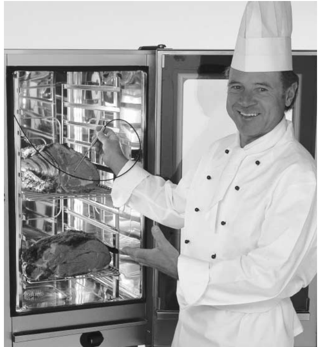
Mit Kerntemperatur garen Sie „auf den Punkt genau“. Fühler mittig positionieren.
