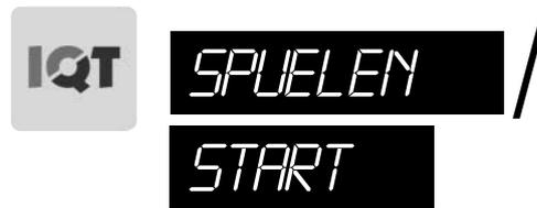
Nach Behebung des Netzausfalls drücken Sie die Programm/Start-Taste solange, bis das Ausspülprogramm startet. Es entfernt eventuell verbliebene Klarspüler- und Reinigerreste aus dem Garraum.
