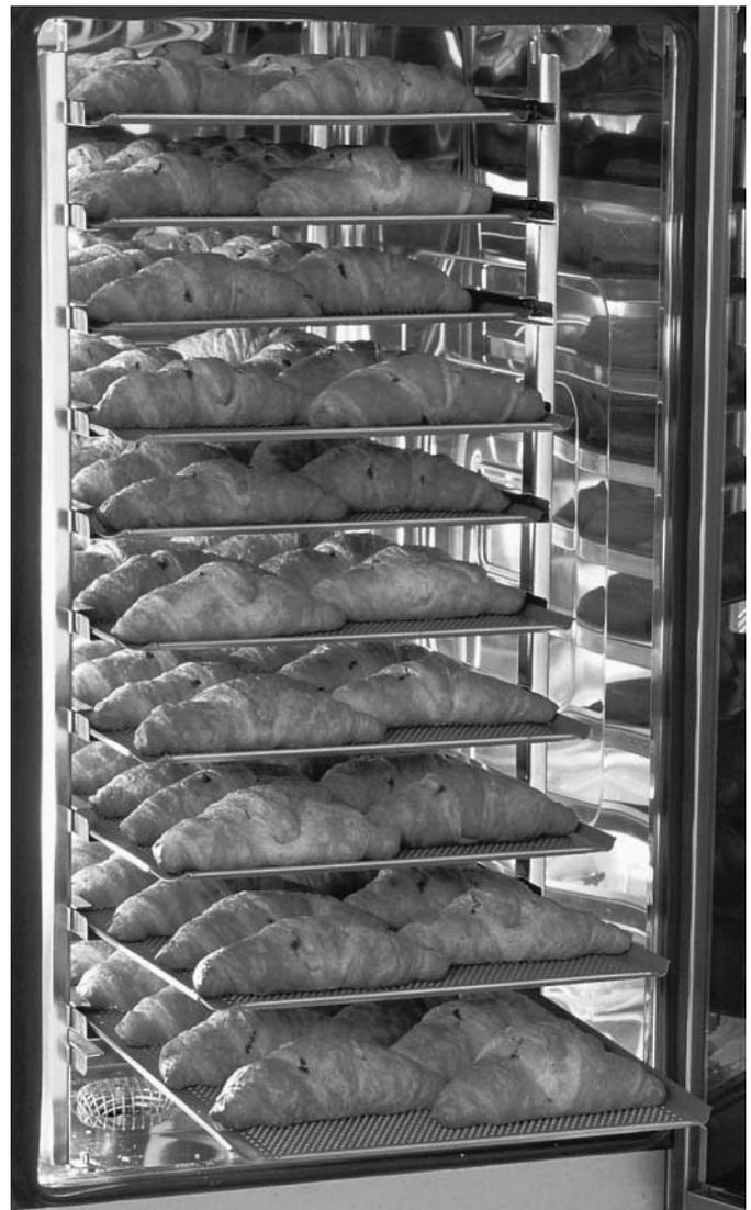
Perforierte Aluleche leiten die Wärme schnell und gleichmäßig an die Unterseite des Backgutes.
