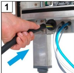
1 Netzanschlussleitung an der Rückseite der Maschine einführen.
