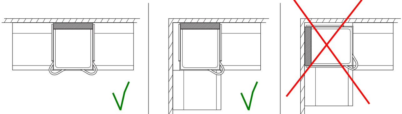
**INFO** Wenn die Maschine über Eck aufgestellt wird, muss der linke Haubengriff ausgebaut werden. Für das Verschließen der Bohrungen steht ein Kit mit der Material-Nr. 30002147 zur Verfügung.
