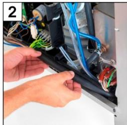
2 Netzanschlussleitung vorne herausziehen und nach links führen.
