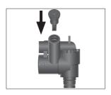
► Setzen Sie den Luftansaugstutzen ein.
